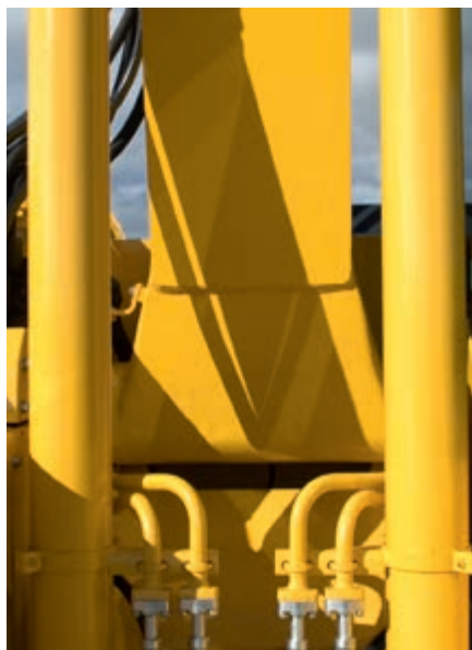
Pied de la flèche en acier moulé
