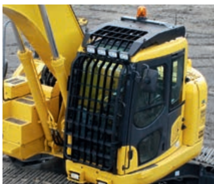
Système FOPS (protection contre les chutes d'objets) en option
