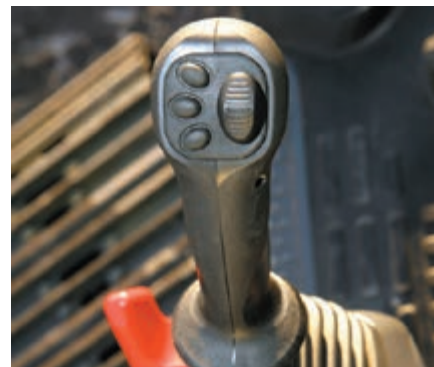
Manipulateurs avec boutons de commande proportionnels pour les accessoires
