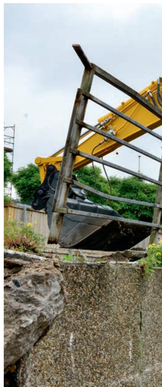
Système FOPS (protection contre les chutes d'objets) en option
