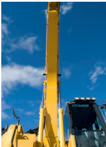
Plaque intégrale de dessous de flèche
