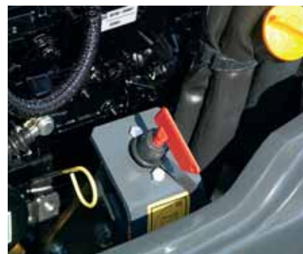
Coupe circuit de l'installation électrique en standard
