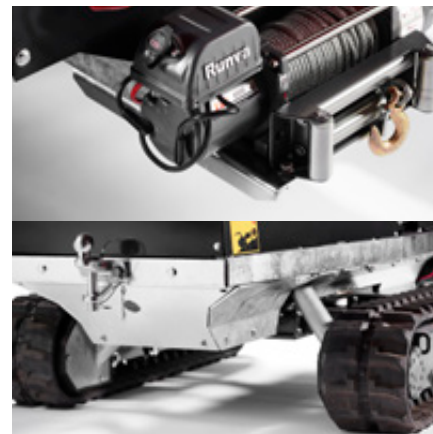
TP Winch pour graver les terrains inclinés. Meilleure garde au sol sur le marché: 200 mm. Largeur de chenilles: 1150 à 1300 mm. Protection renforcé du tube.
