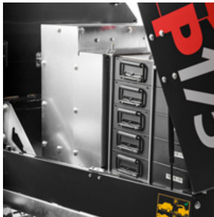
325 Amp (5 heures). Batterie au lithium (LiNiMnCoO2 65V) jusqu'à 5 heures de fonctionnement
