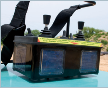
Émetteur infrarouge manuel avec capteurs solaires
