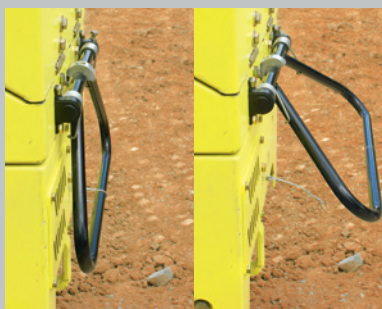
Étrier de sécurité blocable pour la sécurité de l'opérateur
