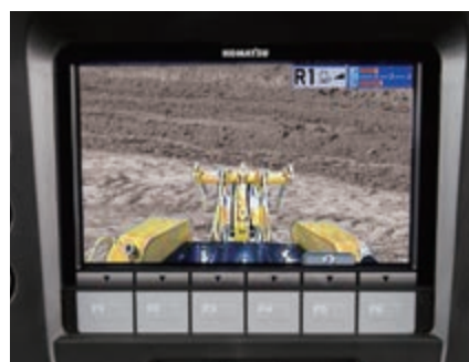
Système de caméra vue arrière complètement intégré
