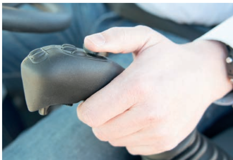
Pour les déplacements fréquents, le levier de direction réglable (en option) permet de contrôler la machine avec un effort moindre
