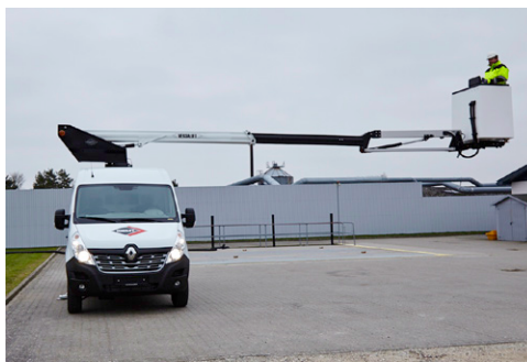
Rotation tourelle et stabilisateurs dans le gabarit des rétroviseurs
