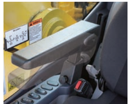
Accoudoir aisément réglable en hauteur
