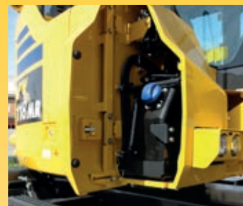
Réservoir d'AdBlue® facilement accessible
