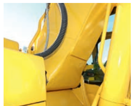
Pied de flèche en acier moulé et plaques de dessous de flèche d'une seule pièce
