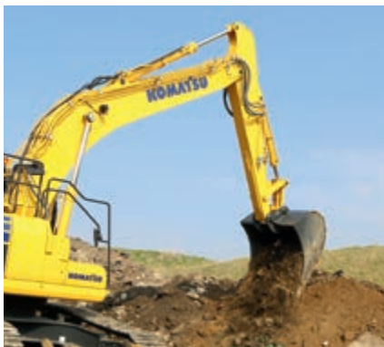
Choix entre quatre longueurs de balancier Flèche monobloc ou à volée variable
