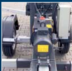
Essieu rétractable, largeur de manœuvre de 0,89 m (en option)
