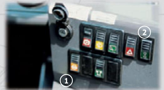
② - Le relevage électro-hydraulique de la cabine facilite l'accès aux organes mécaniques pour effectuer la maintenance.
