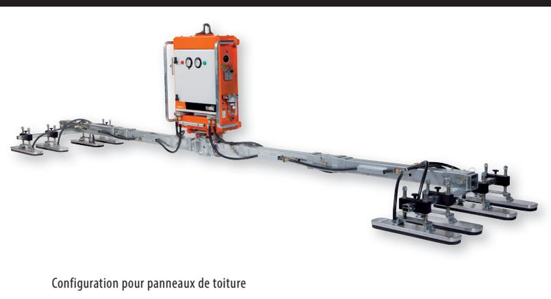
Configuration pour panneaux de toiture
