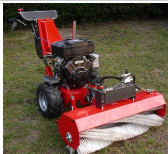
Balayeuse avec centrale hydraulique pour UBS HYDRO
